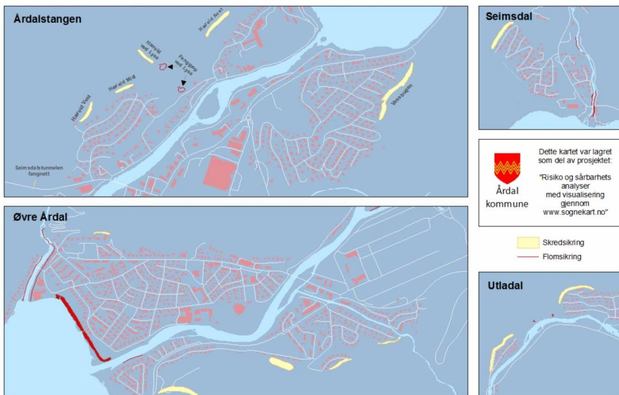
Figur 3.9: Oversiktskart over dei etablerte skredsikringstiltaka som er gjennomført på Årdalstangen, i Seimsdalen, Øvre Årdal og Utladalen.
