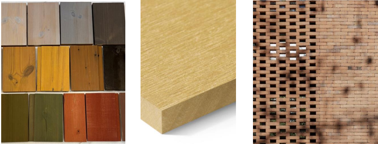
Figur 36: Eksempel på aktuelle materialer Til venstre: Woodify (Thermowood). I midten: Fibersement (Swisspearl). Til høyre: Ombrukstegl (Foto Pinterest).
