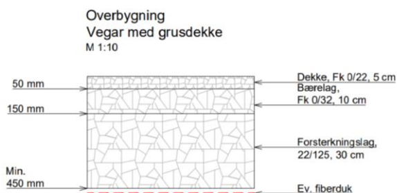
Figur 61: Illustrasjon av oppbygging av vegar med grusdekke.
