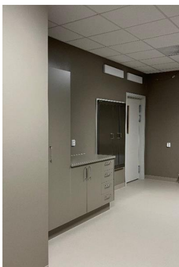
Figur 45: Illustrasjonsbilde frå skyljerom Åsaheimen, Bergen. Til venstre rein side, Til høgre urein side med gjennomstikkskap.
