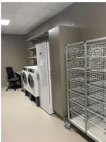
Figur 45: Illustrasjonsbilde frå skyljerom Åsaheimen, Bergen. Til venstre rein side, Til høgre urein side med gjennomstikkskap.
